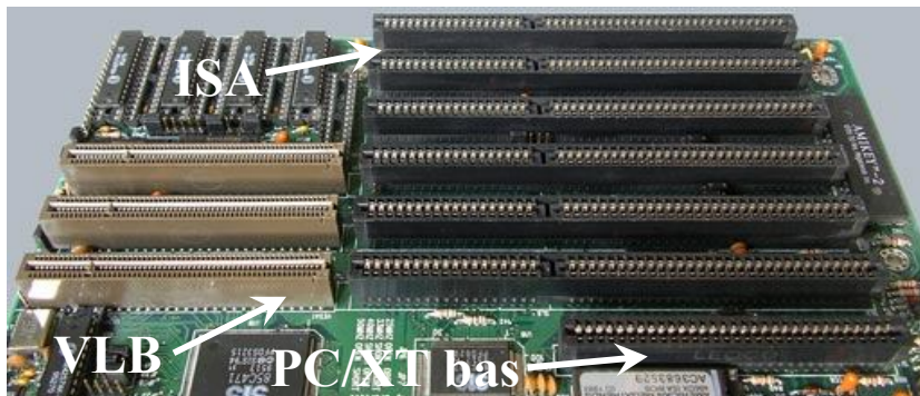
Рис. 25. Вид слотов шин PC/XT bus, ISA и VLB
