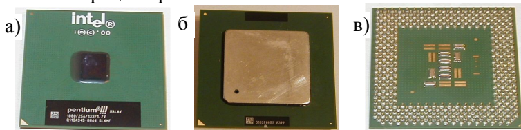
Рис. 37. Корпуса микропроцессоров начиная с Pentium II: а) FCPGA; б) FCPGA2; в) низ МП FCPGA и FCPGA2.
