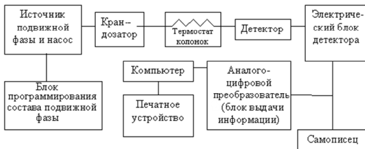
Рис. 6.7. Блок-схема жидкостного хроматографа
