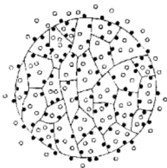
Рис. 6.2. Изображение структуры частицы ионообменной смолы: ● – заряженные функциональные группы; ○ – свободно перемещающиеся противоположно заряженные ионы, электростатически связанные с частицей смолы, способные претерпевать обмен с другими ионами.
