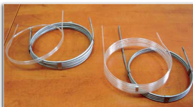
Рис. 5.5. Колонки насадочные металлические и стеклянные
