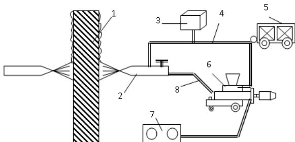
Рис. 16. Обработка поверхностного слоя конструкций с помощью торкретирования
