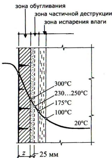
Рис. 14. Влияние температуры нагрева на свойства древесины
