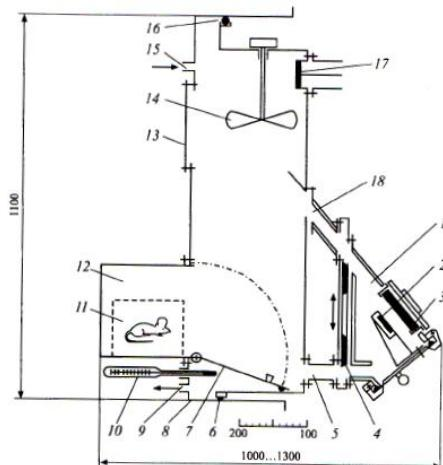
Рис. 10. Установка для определения показателя токсичности
