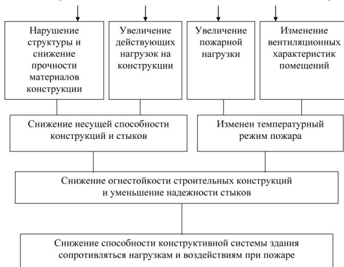
Рис. 17. Схема причин снижения устойчивости здания при пожаре
