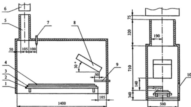
Рис. 7. Установка для испытаний на распространение пламени
