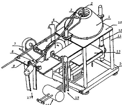
Рис. 5. Общий вид установки для испытаний на воспламеняемость
