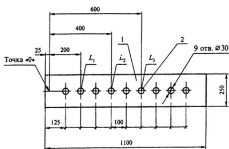
Рис. 8. Калибровочный образец
