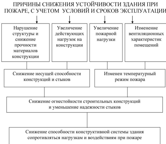
Рис. 17. Схема причин снижения устойчивости здания при пожаре
