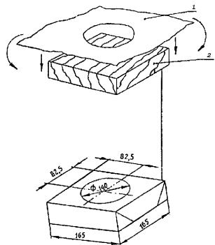
Рис. 6. Подготовка образца к испытанию
