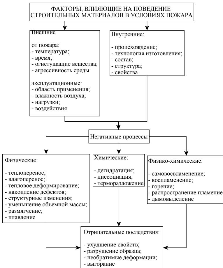
Рис. 1 Закономерности поведения строительных материалов в условиях пожара
