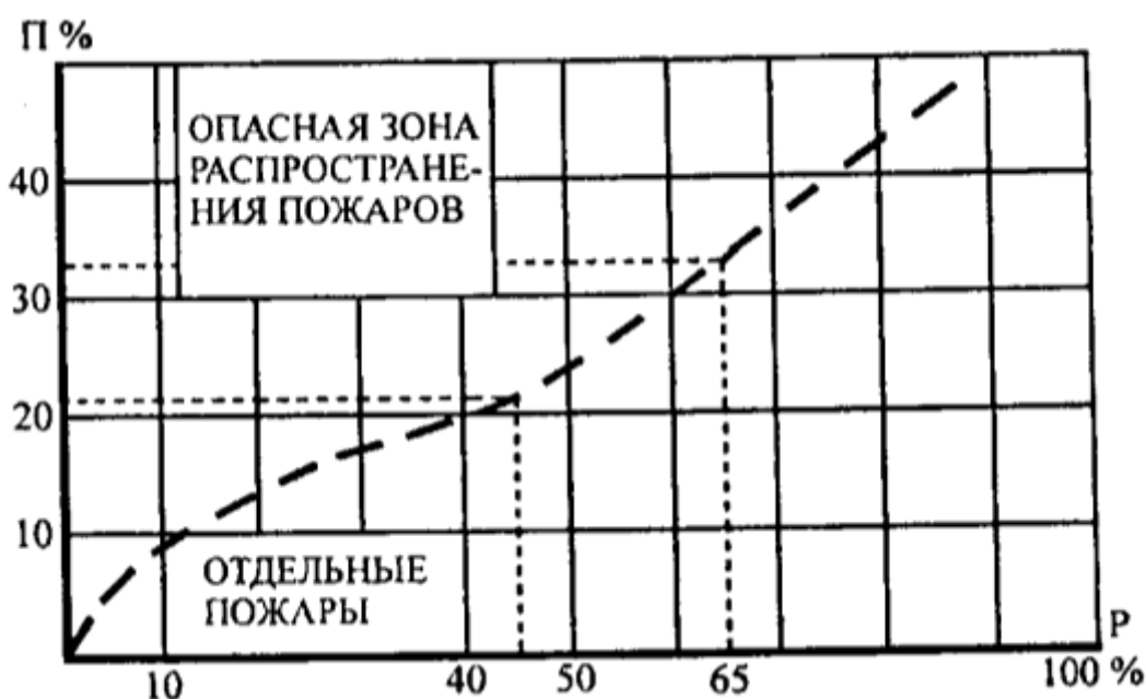
Рисунок 10 Зависимость вероятности возникновения и распространения пожаров от плотности застройки
