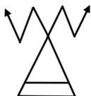
Ретранслятор базовой станции транкинговой сети подвижной связи (общее обозначение).
