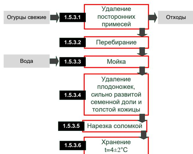
Рисунок 1.4 - Блок-схема изготовления полуфабриката из свежих огурцов
