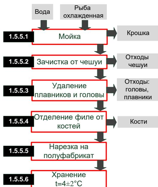
Рисунок 1.6 - Блок-схема технологии изготовления рыбного полуфабриката
