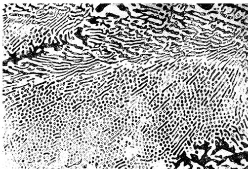
Рис. 65. Микроструктура белого эвтектического чугуна:
