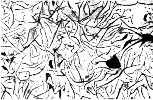
Рис. 61. Микроструктура серого литейного ферритного чугуна; X 200
