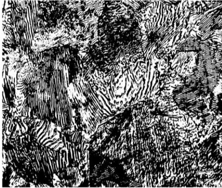
Рис. 58. Микроструктура эвтектоидной стали – перлит, X 500
