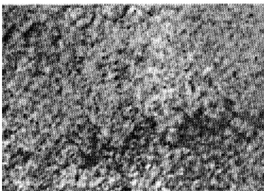
Рис. 11.2б. Электронная микрофотография сплава Al + 4,1 % Cu (г 2500г 2): зонная стадия распада \alpha -твердого раствора (зоны Г.-П.И)
