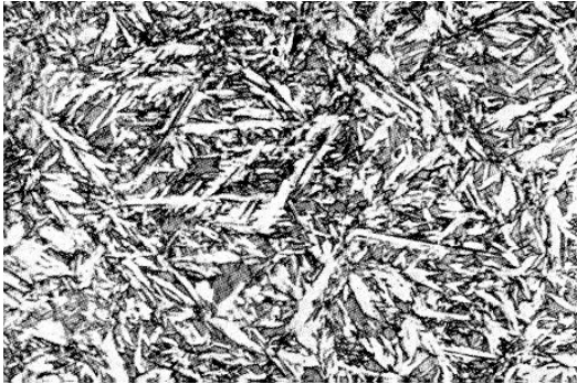
Рис. 8.1. Микроструктура закаленной низкоуглеродистой (0,15 % C) стали, \tau 200
