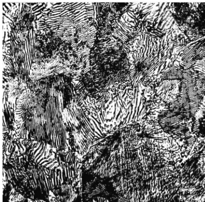
Рис. 5.6. Микроструктура эвтектоидной стали с пластинчатым перлитом, \times 200
