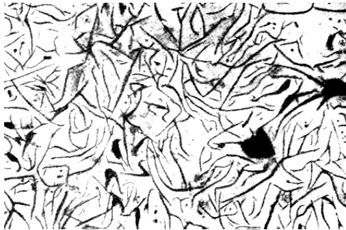
Рис. 6.1. Микроструктура серого литейного ферритного чугуна, \tau 200
