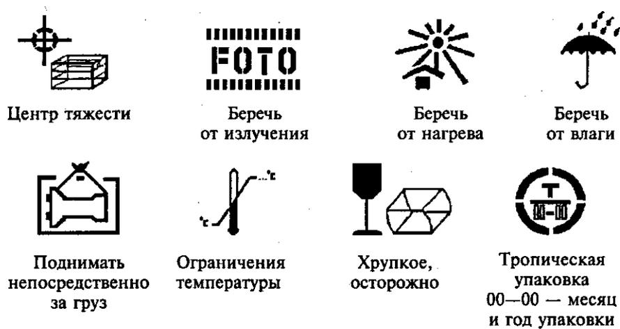
Рис. 3. Манипуляционные знаки по ГОСТ 14192-77, используемые при маркировке груза
