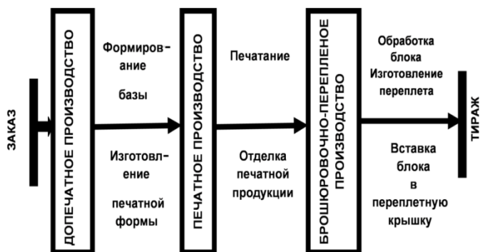
Рис. 2. Общая схема производственного потока Workflow для изготовления печатной продукции
