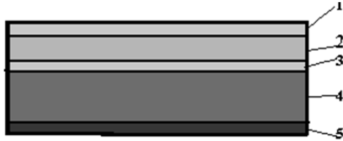
Рис. 25. Строение фотографической пленки для черно-белой фотографии: 1 – защитный слой; 2 – эмульсионный слой; 3 – подслои; 4 – подложка; 5 – противослой (противоореальный слой)
