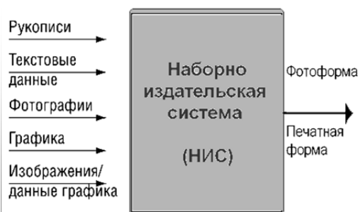
Рис. 27. Схема допечатных процессов с использованием НИС
