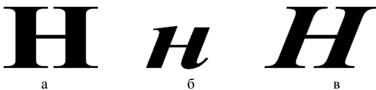
Рис. 11. Классификация шрифтов по положению очка: а – нормальные, б – курсивные, в – наклонные
