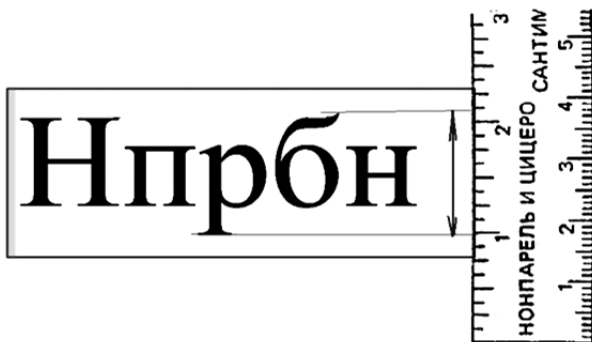
Рис. 7. Пример измерения кегля шрифта строкомером
