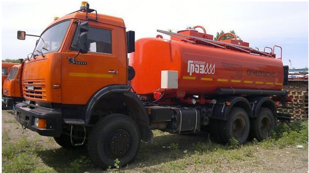
Рисунок 1.3 - Автоцистерна для подвоза нефтепродуктов
