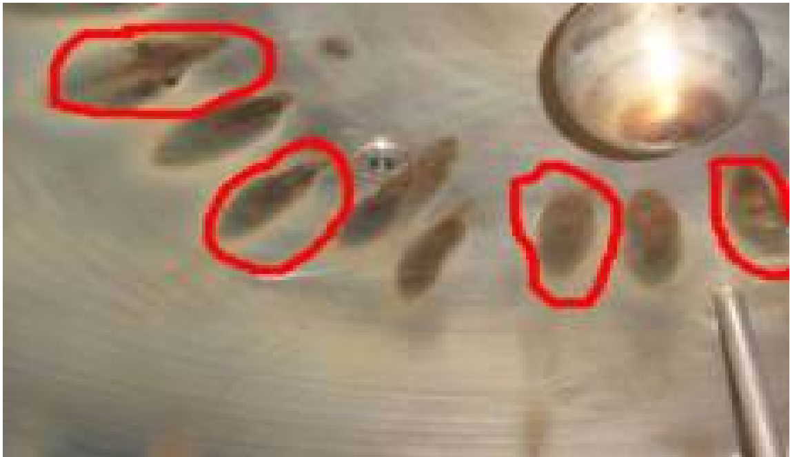
Рисунок 6 — разрушенная внутренняя поверхность емкости при использовании статической шаровой моющей головки.
