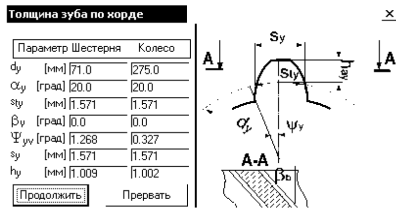
Рисунок 4.12 - Окно программы APM WinMachine с определенной толщиной зуба на хорде
