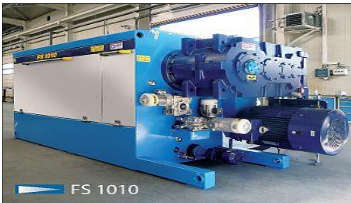
Рисунок 8 – Шнековый маслопресс FS 1010.
