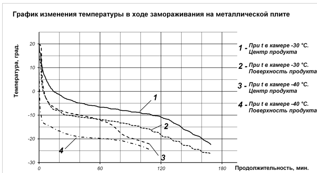
Рисунок 4.2 – График изменения температуры в ходе замораживания на металлической плите
