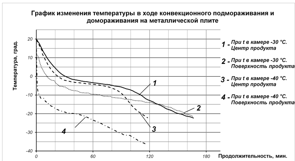
Рисунок 4.4 – График изменения температуры в ходе конвекционного подмораживания и домораживания на металлической плите
