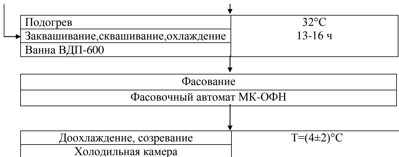
Рисунок 7 – Графическая схема производства сметаны 15,0 %
