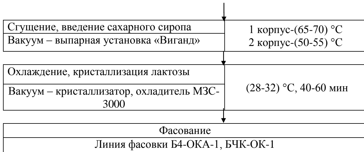
Рисунок 4 – Графическая схема производства сгущенного цельного молока с сахаром 8,8% (сливок сгущенных с сахаром 19%, молока нежирного сгущенного с сахаром)
