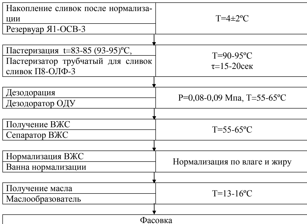
Рисунок 10 – Схема технологического процесса производства масла сливочного «Крестьянского» с массовой долей жира 72,5%
