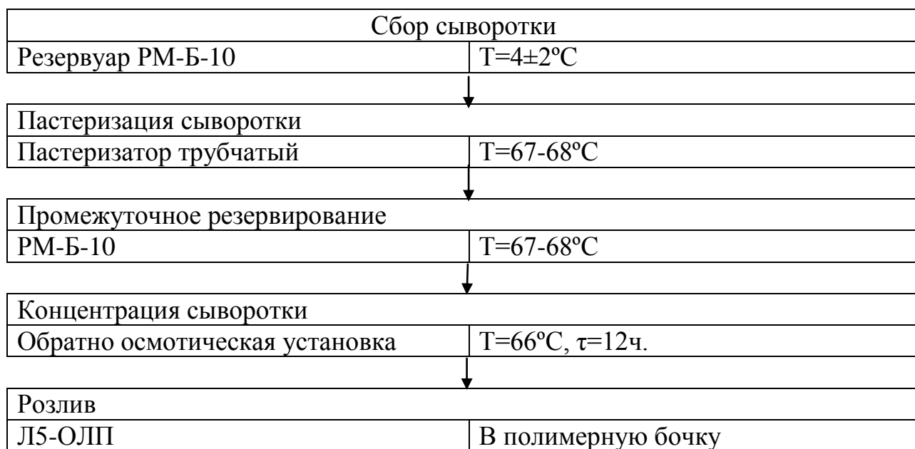
Рисунок 12 – Схема технологического производства сыворотки концентрированной с массовой долей сухих веществ 20%
