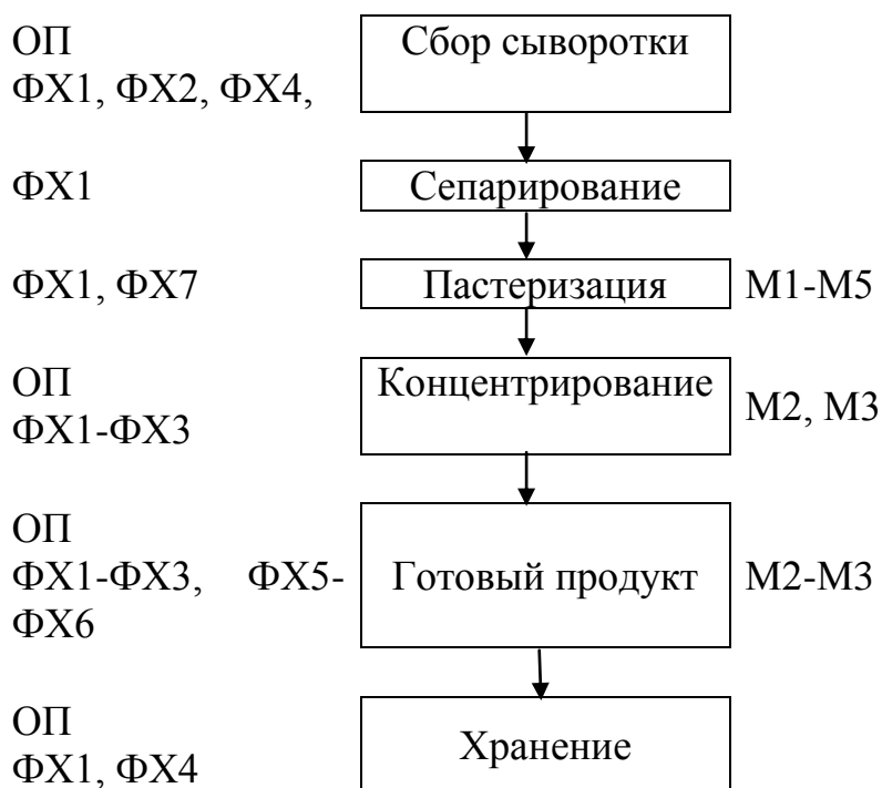
Блок-схема 7 – Производство сыворотки концентрированной»
